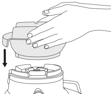
2. Justér pilene i bunden af filterkurven af rustfrit stål med pilene på motordrevskoblingen, og skub den ned, indtil den klikker på plads for at skabe en sikker tilpasning med motordelen.
