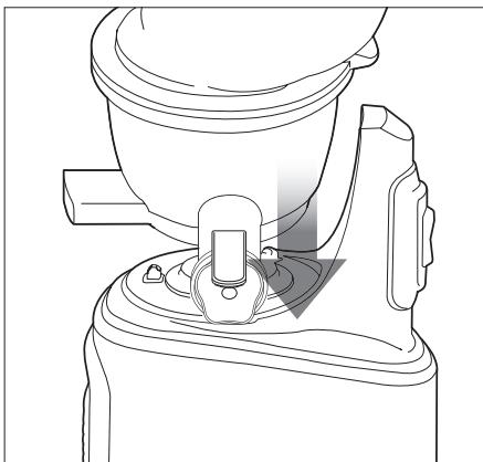
6. Zorg dat de pijltjes op het trommeldeksel en de motorbehuizing zijn uitgelijnd.
