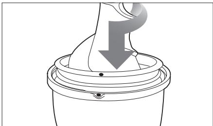
De persschroef moet zijn vergrendeld om het trommeldeksel te sluiten.
