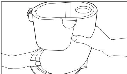
5. Allineare il punto rosso ● sul coperchio del fusto con il segno ALIGN (allineamento) presente sulla base e ruotare nella posizione CLOSE (chiusura).
