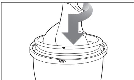
Die Entsafterschraube muss richtig eingesetzt sein, damit sich der Deckelaufsatz schließen lässt.
