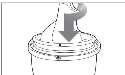
La vis d'extraction de jus doit être verrouillée en place pour fermer le couvercle du tambour.
