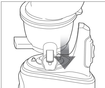
6. Alignez les flèches sur le couvercle du tambour et le bloc moteur.
