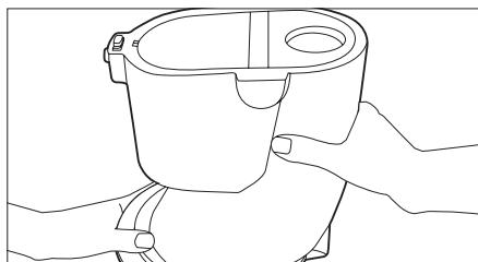
5. Alignez le point rouge ● sur le couvercle du tambour avec la marque ALIGNEMENT sur le corps et faites tourner vers la position FERMETURE.
