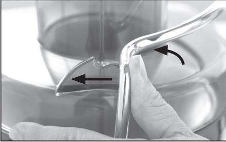
6. Stopfer so in den Einfüllschacht einschieben, dass die Einkerbung am Stopfer auf dem kleinen Vorsprung im Innern des Einfüllschachts sitzt.
