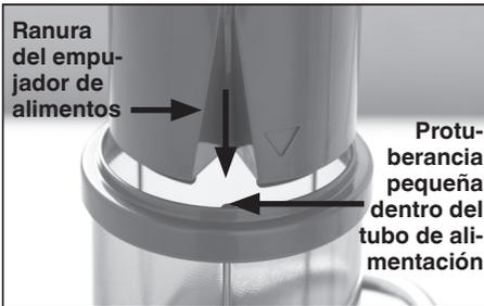
Sigue deslizando el empujador de alimentos hacia abajo por la abertura para alimentos.
