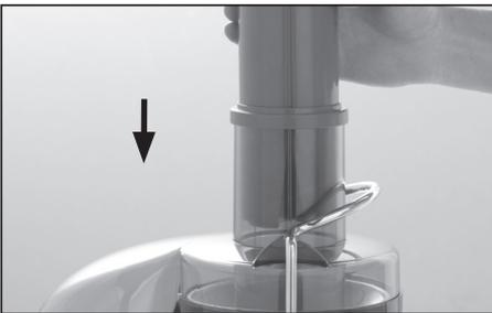
7. Zum Einsetzen des Tresterbehälters Motorfuß leicht nach rechts kippen. Tresterbehälter links unter dem Entsafterdeckel so einschieben, dass er vom Entsafterdeckel und Motorfuß in Position gehalten wird.
