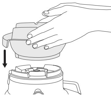
2. Zorg dat de pijltjes op de basis van de filtermand zijn uitgelijnd met de pijltjes op de koppeling van de motoraandrijving, en duw de filtermand omlaag totdat deze vastklikt en stevig op de motorbasis is bevestigd.
