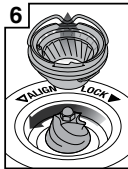
6 Oberes Mahlwerk entfernen
